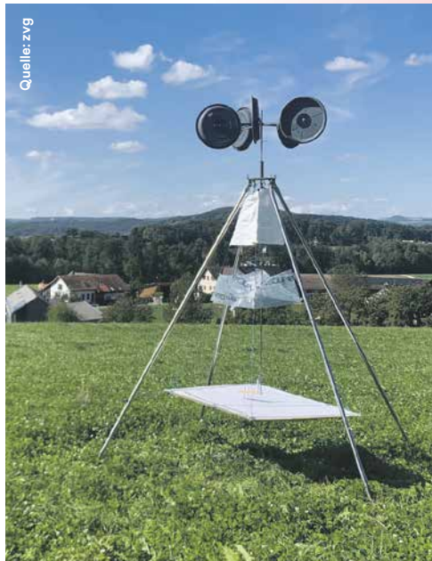
Quelle: zvg Simone Maurers Windmaschine: Das Papier liegt auf der mit dem Wind schwingenden Platte.
